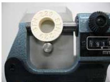
Аналоговые и цифровые микрометры имеют эргономичную базу с устройством, которое обеспечивает правильное позиционирование кольца. Такая конструкция упрощает процесс измерения и повышает воспроизведение результатов измерений.
